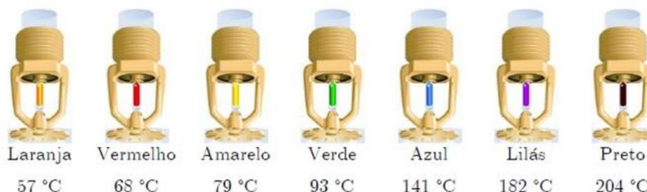
Figura 69 - Temperaturas de rompimento de chuveiros de *sprinklers* conforme a cor
